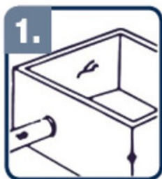
Před aplikací zdrsňte a odmaštěte plochu. (Pro odmaštění použijte 123 Fluid Extra)
