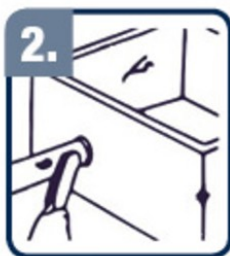
Přitiskněte bandáž a nechte vytvdřit UV zářením. (Slunce - 50 min. / UV lampa - 5 min.)
