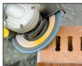
Mop Spezial brousí hrany na dlaždicích a betonových blocích s vysokou mírou účinnosti.
