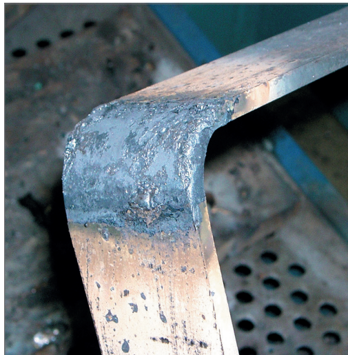
Povrch materiálu není poškozen.
